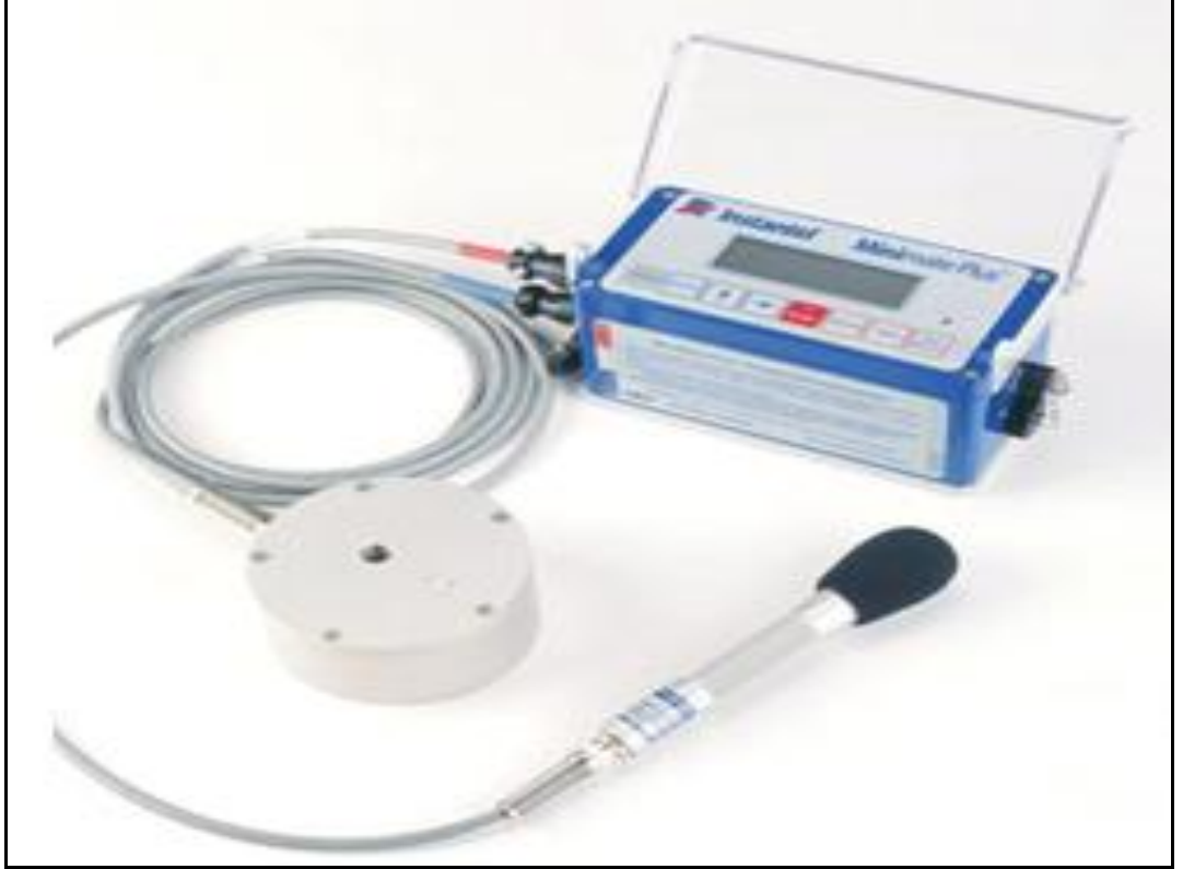
Şekil 3.3. Instantel Mini Mate Plus model titreşim ölçüm cihazı
