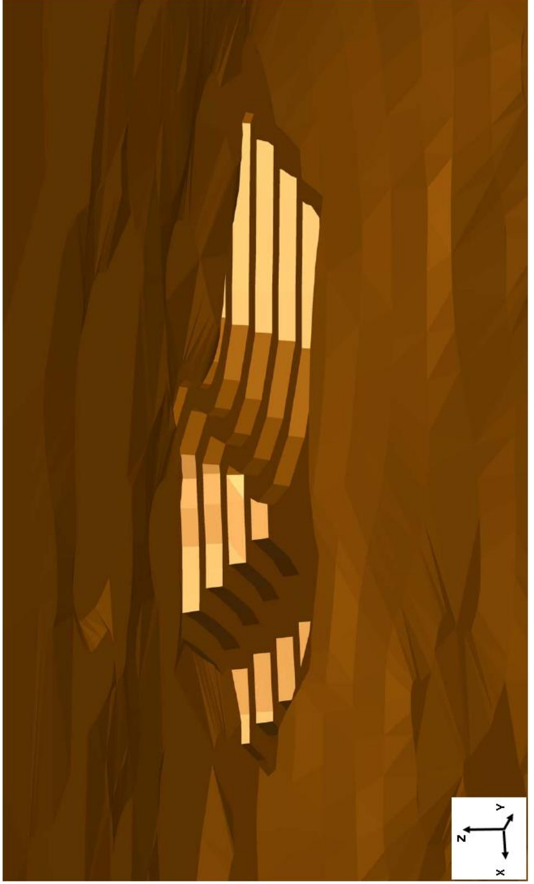
EK-4: BASAMAK GENİŞLİĞİ 15 M. ALINARAK OLUŞTURULMUŞ AÇIK OCAK TASARIMI
