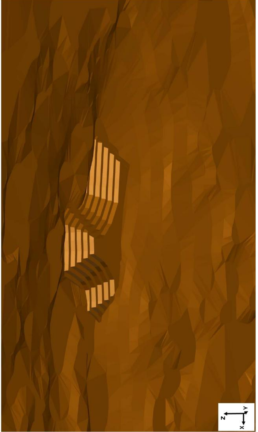
EK -3: BASAMAK GENİŞLİĞİ 10 M. ALINARAK OLUŞTURULMUŞ AÇIK OCAK TASARIMI
