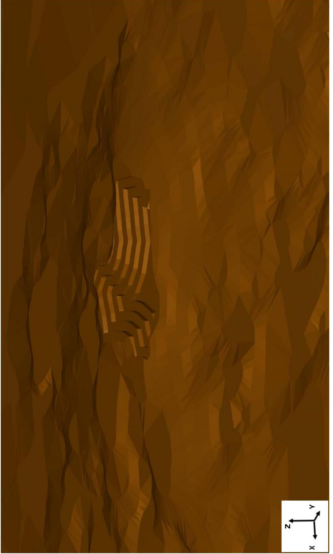
EK-5: BASAMAK GENİŞLİĞİ 20 M. ALINARAK OLUŞTURULMUŞ AÇIK OCAK TASARIMI
