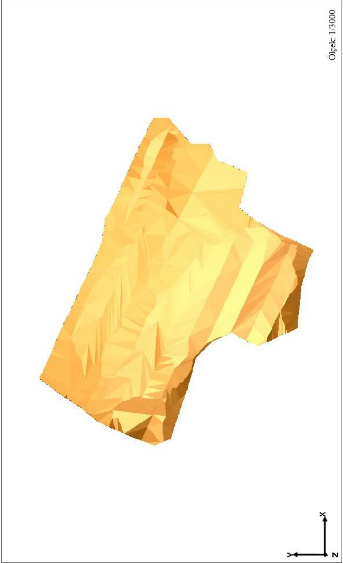
Şekil 4.10 : DTM modülü kullanılarak oluşturulan 3 boyutlu çevher katı modeli
