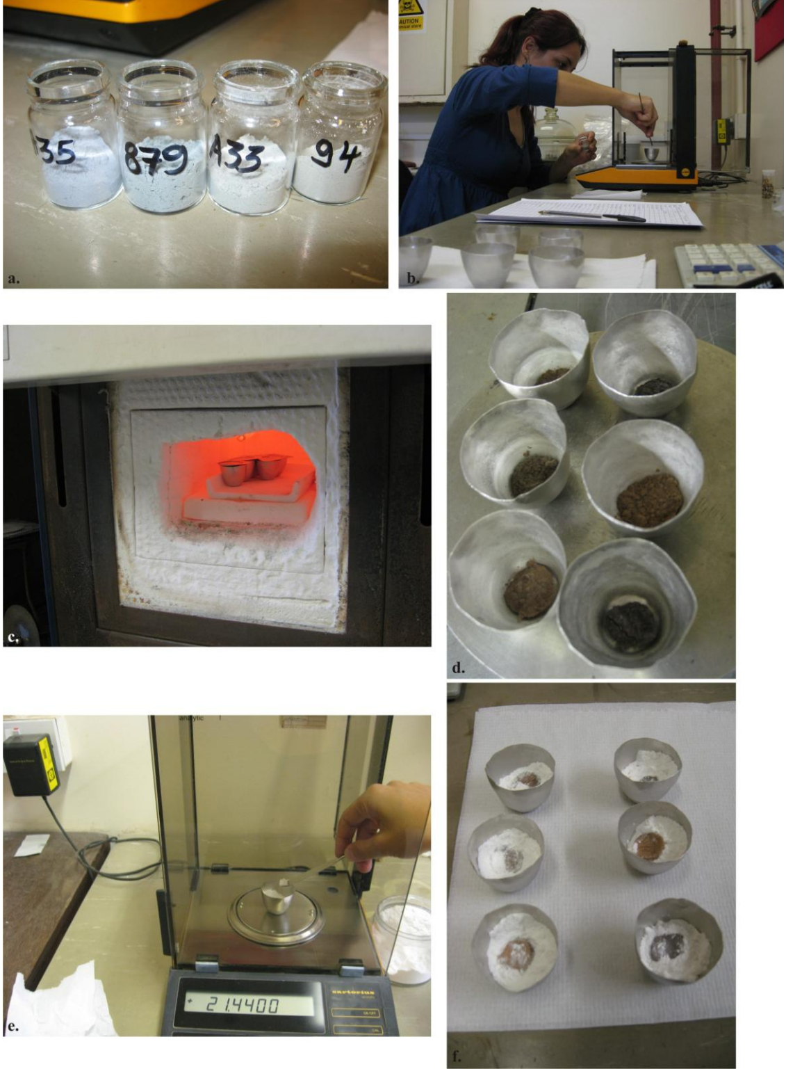
Şekil 3.1.a. Cam disk ve pellet hazırlamak için 1 gece etüvde bırakılacak olan toz örnekler cam şişeler içine alınır. b. Toz örneklerin platin kroze içinde tartılması. c. Platin kroze içindeki toz örneğin 20 dakika 1100°C deki etüvde bekletildikten sonra çıkarılması. d. Fırından çıkarılan toz örnekler. e ve f. Specroflux tozunun fırından çıkarılan toz örnek üzerine eklenmesi.
