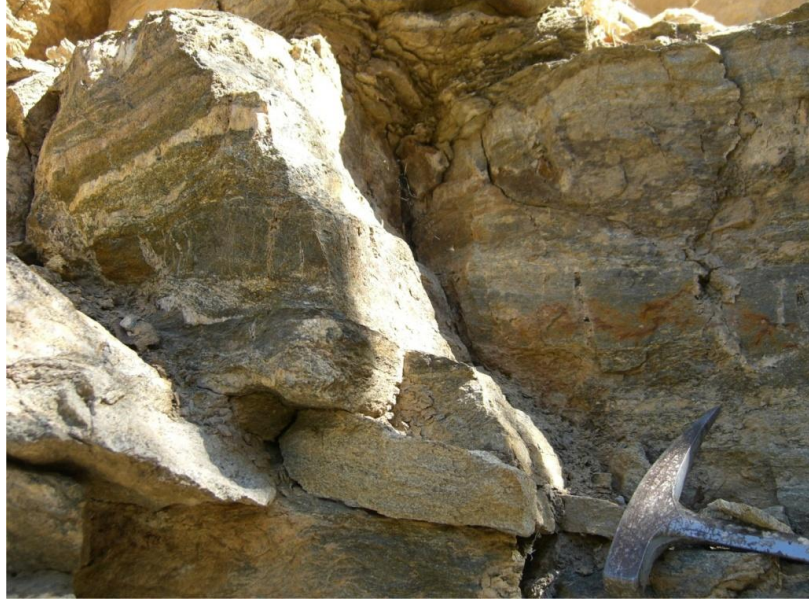
Şekil 4.9. Genellikle gri renkli pelitlerden oluşan Kocasu Formasyonu içinde daha açık renkli, kuvarsa zengin psamitik seviyeler.
