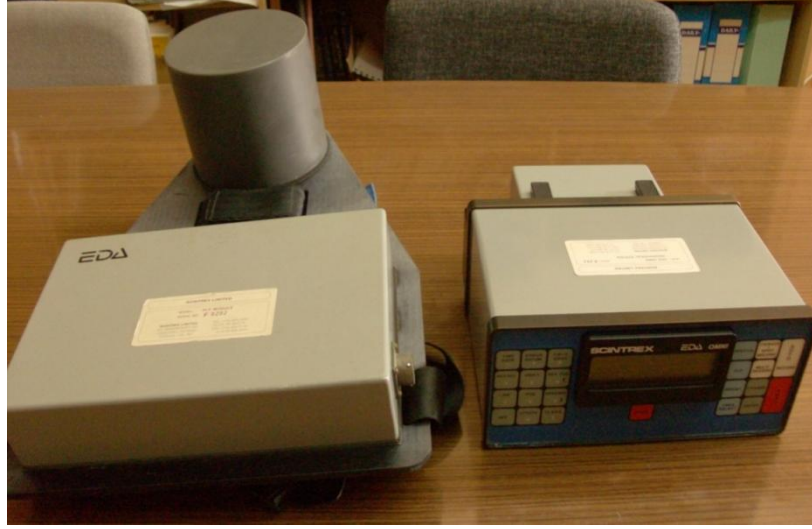
Şekil 4.4. Arazide elektromanyetik – VLF ölçümlerinde kullanılan Kanada yapımı SCIENTREX EDA OMNI PLUS cihazı.
