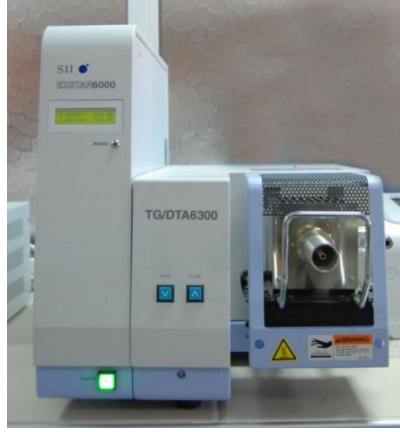
Şekil 3.4: Isıl analizlerin gerçekleştirildiği TG/DTA sistemi.
