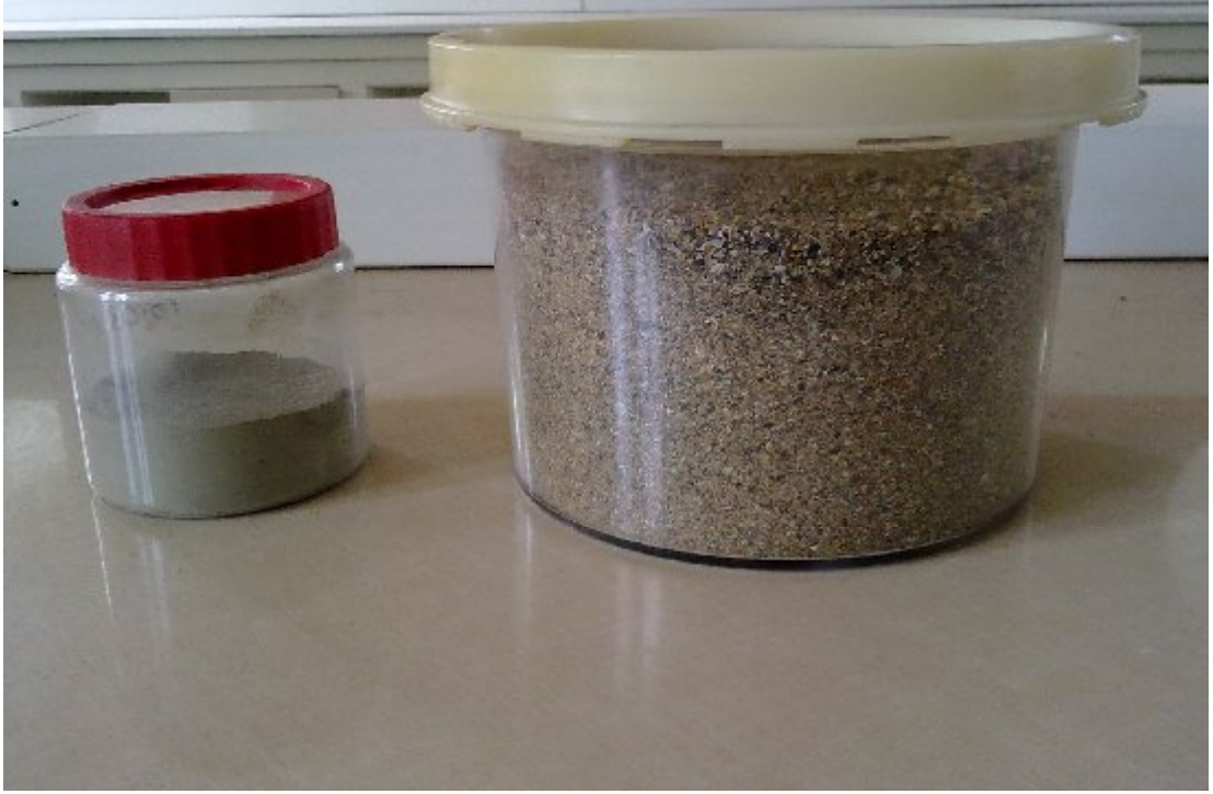
Şekil 3.3: 170 ml'lik ölçüm kabında < 63 \mu\text{m} sediment fraksiyonu ve 1 l'lik Marinelli kaptaki > 63 \mu\text{m} sediment fraksiyonu örnekleri
