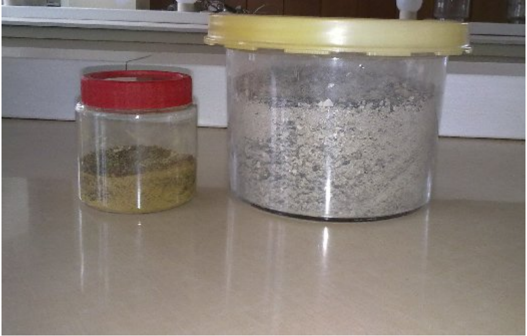
Şekil 3.2: 170 ml'lik ölçüm kabında midye iç dokusu ve 1 l'lik Marinelli kaptaki midye kabuk dokusu örnekleri
