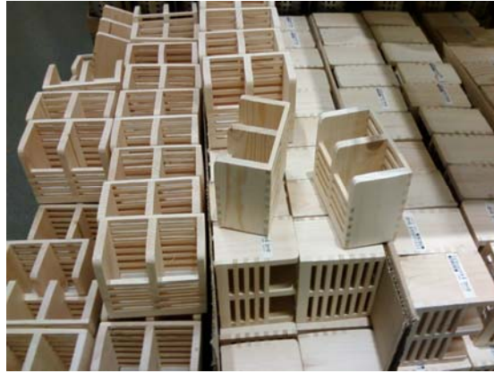
Şekil 4.12: Masif panelden yapılmış mutfak aksesuarları(Foto: Bilgin 2009)
