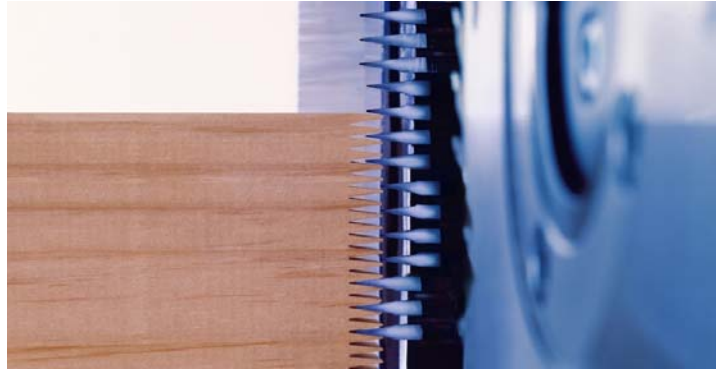
Şekil 2.52: Finger joint makinesinde parmak dişlerin açılması (Grecon,2010)
