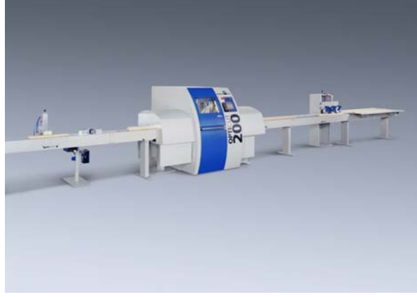
Şekil 2.47: Otomatik boylama ve budak ayırma makinesi (Dimter, Opticut 200 Elite,2010)
