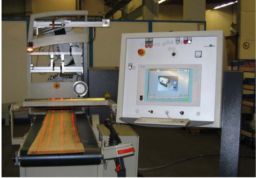
Şekil 2.46: Çoklu dilme makinesinde lazer ve testerelerin kalite sınıfına göre hareketi (Raimann,2010)
