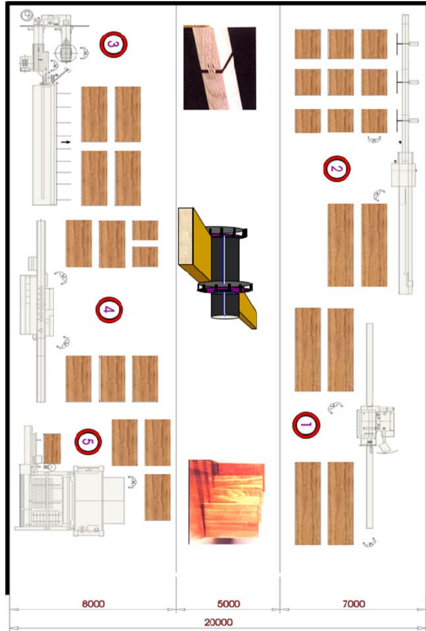
Şekil 2.64: Masif Panel Fabrikası Üretim İş Akışı ve Fabrika Yerleşim Planı Örneği (Weinig,2010)
