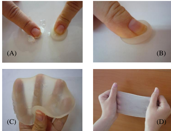
Şekil 4.25. PEG(600)DMA ve CloisiteNa ile sentezlenmiş ürünlerin baskı altındaki davranışları. (A): H-10 ve H-C10 ürünü; (B), (C), (D): H-C10 ürünü.
