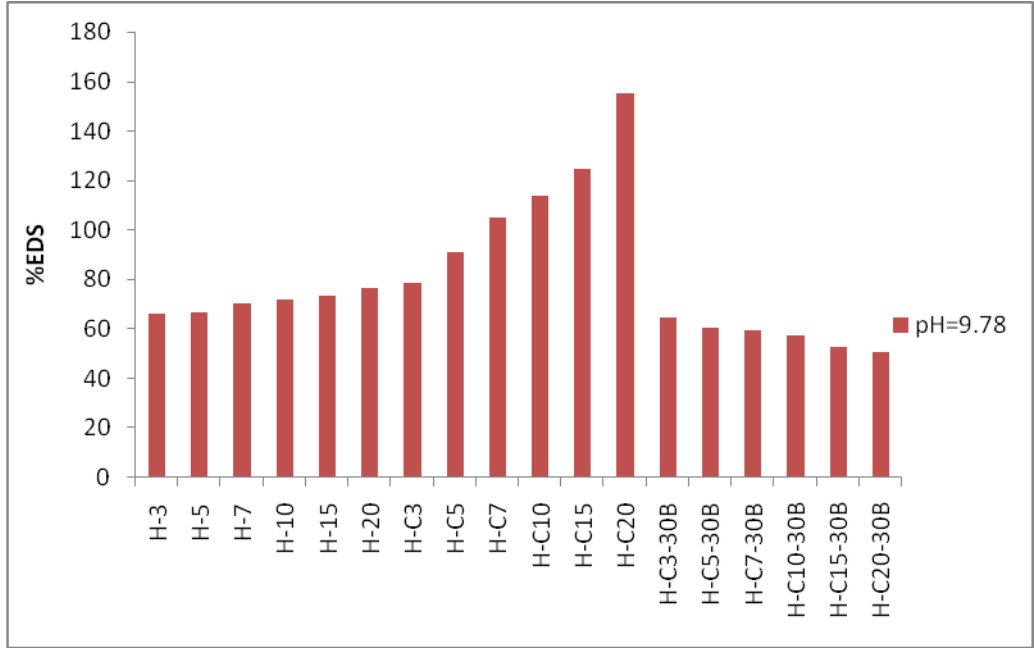
Şekil 4.52. Hidrojellerin ve hidrojel nanokompozitlerin pH'ı 9.78 olan tampon çözeltisi içindeki EDS değerleri
