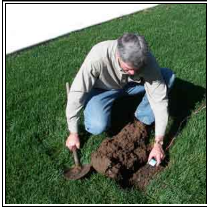
Şekil 2.9 Toprağa yerleştirilen nem sensörü (Anonim, 2010a).
