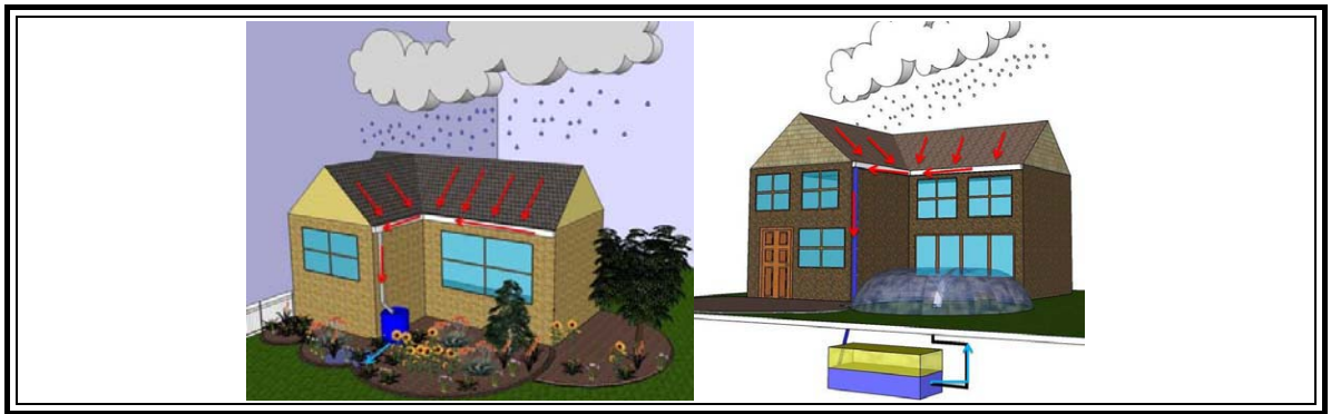
Şekil 2.21 Çatıdan gelen yağmur sularının toplanması (Anonim, 2008a).
