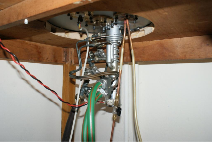
Şekil 3.2 Vakum pompası düzeneği. Mekanik pompa ve difüzyon pompası birlikte kullanılmıştır. Difüzyon pompası ve mekanik pompa birbirlerinden kelebek valfle ayrılmaktadır. Bu valf sayesinde mekanik pompa tek başına çalışabilme yeteneğine de sahiptir.
