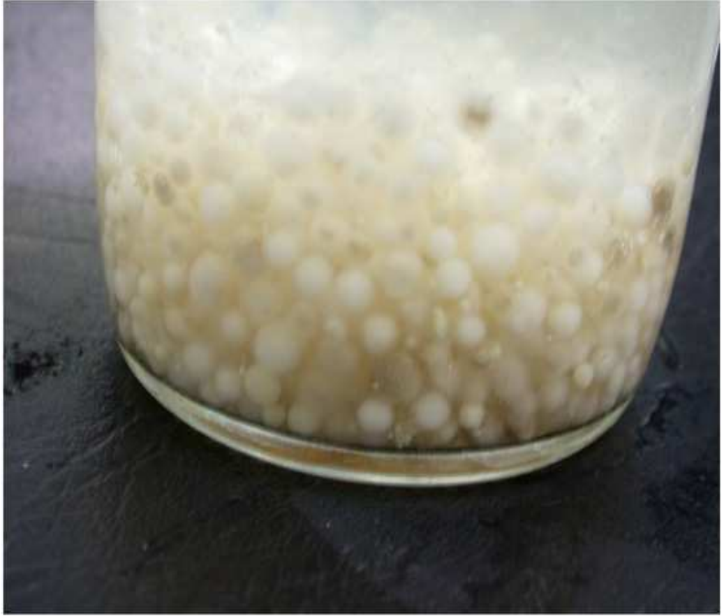
Şekil 2.7 1000 mg/L asetat içeren atıksu beslenen aerobik granüllerin görünümü (Tay vd., 2008)
