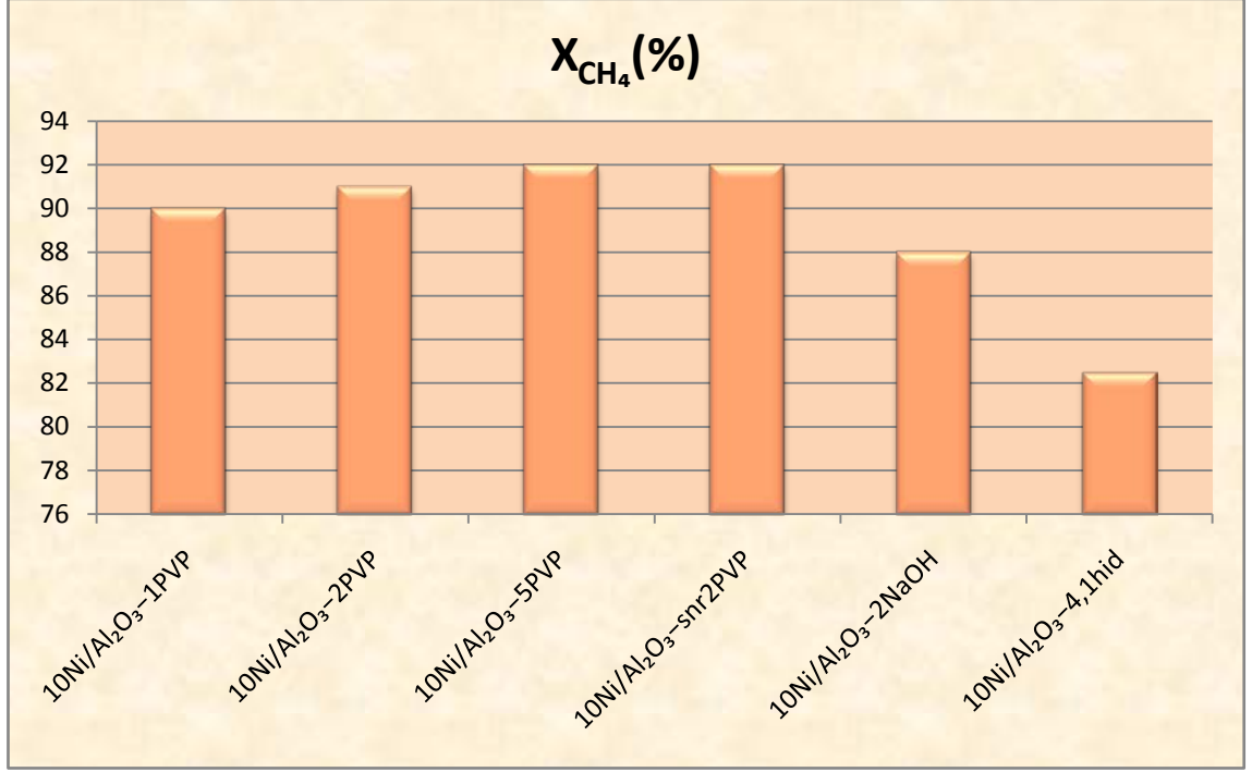
Şekil 4.24: Test edilen katalizörlerden en iyi aktivite gösterenlerin 800°C’de gösterdikleri CH 4 dönüşümleri
