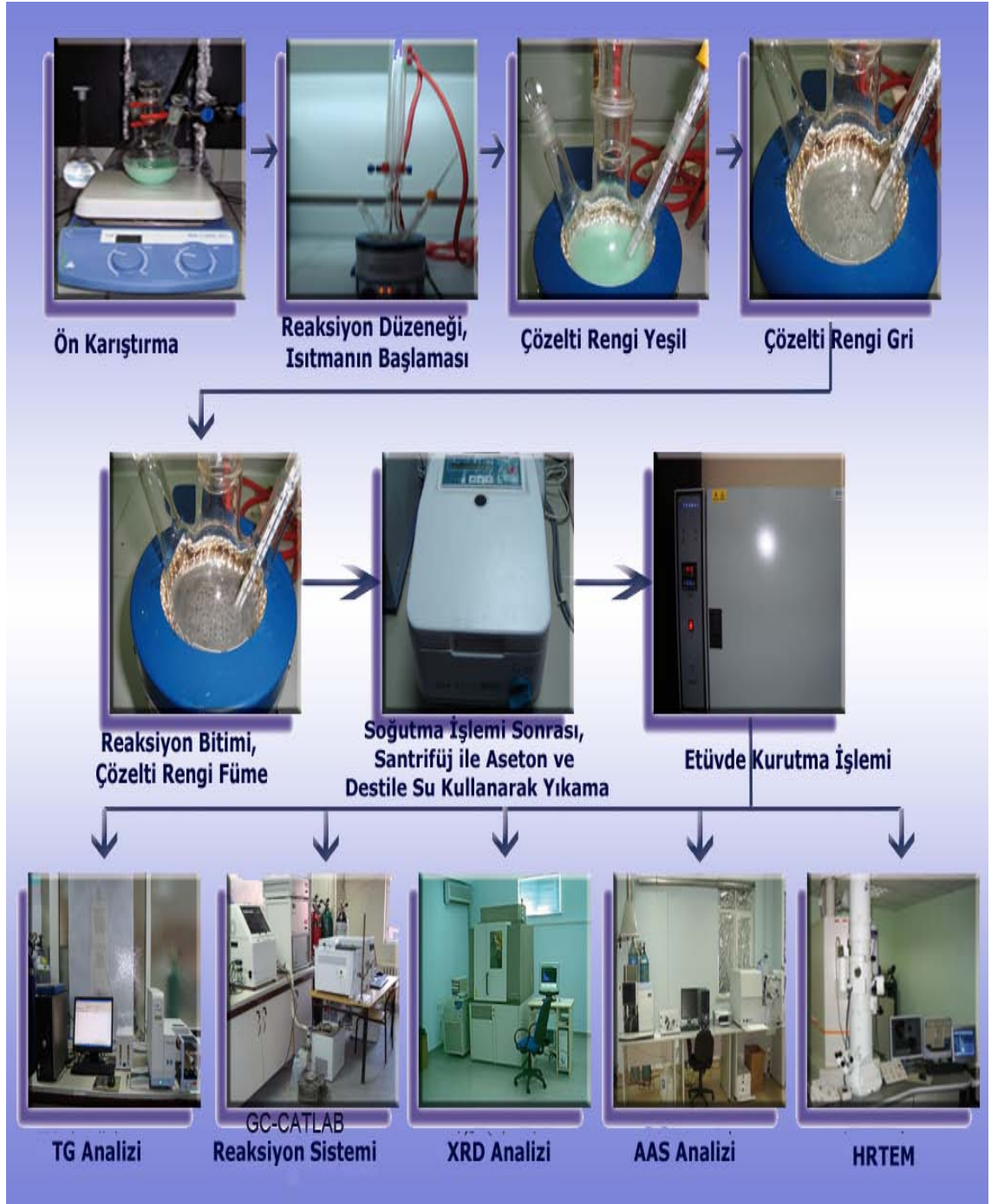
Şekil 4.27: Poliöl yöntemiyle katalizör hazırlama ve karakterizasyon akış şeması
