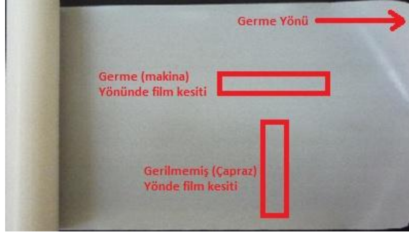
Şekil 4.40: Sünme testlerinde makine yönünde (MY) ve çapraz yönde (ÇY) filmlerin kesimi
