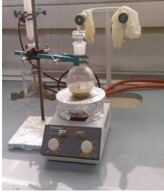
Şekil 3.5: Doğal klinoptilolit GYAM'lar ile modifikasyonunda kullanılan deney düzeneği
