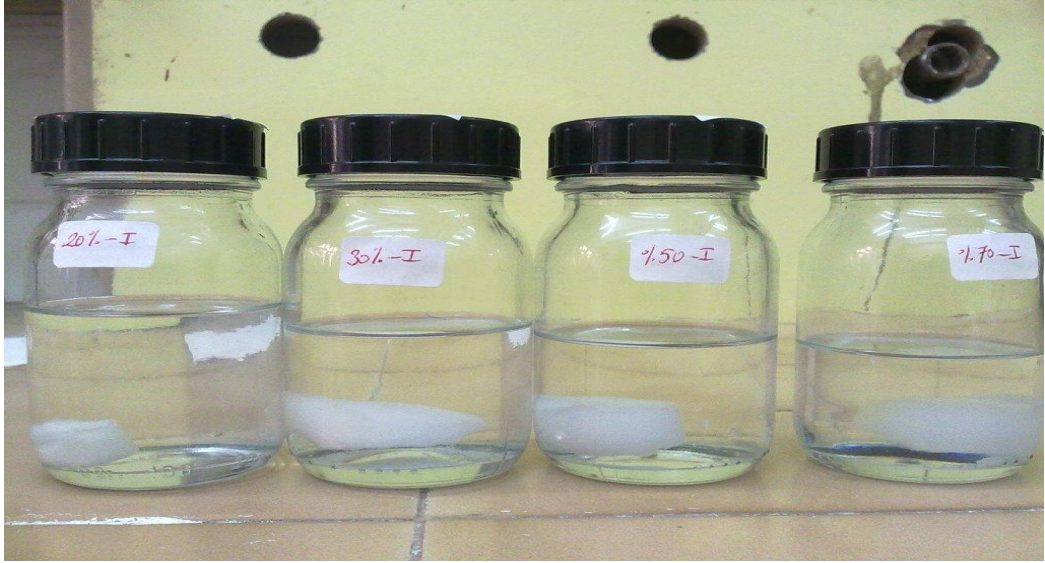
Şekil 4.1 P(VK-ko-DDMA)-1 jelinin farklı oranlardaki karışımlarının görüntüleri
