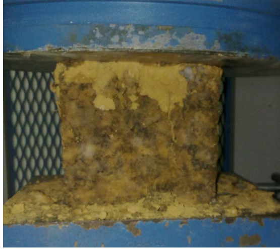
Şekil 4.4: OK3-28 Numunesinin basınç deneyi
