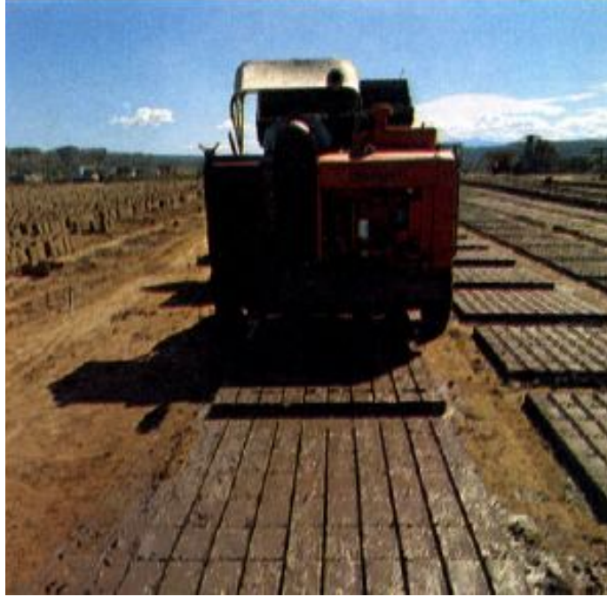
Şekil 2.7: Günlük 20.000 adet kerpiç üretimi yapabilen makine, New Mexico [12]
