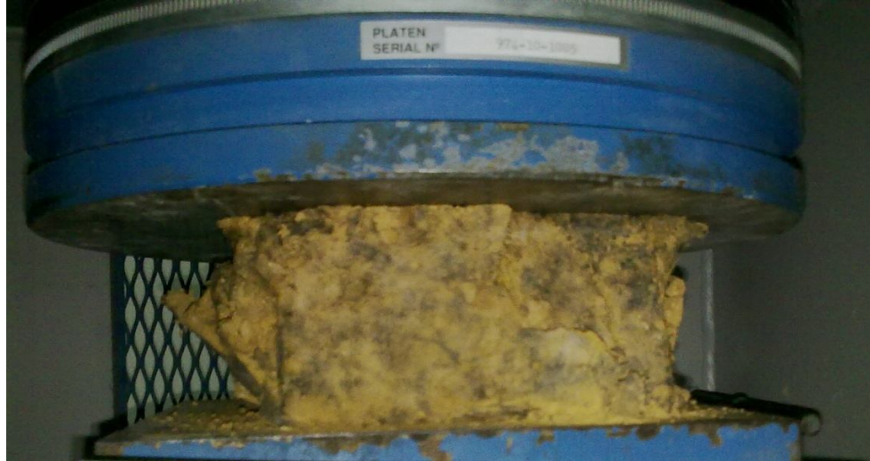
Şekil 4.7: 2K3-28 Numunesinin basınç deneyi
