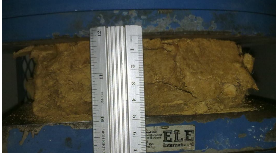
Şekil 4.6: 5K3-28 Numunesinin basınç deneyi
