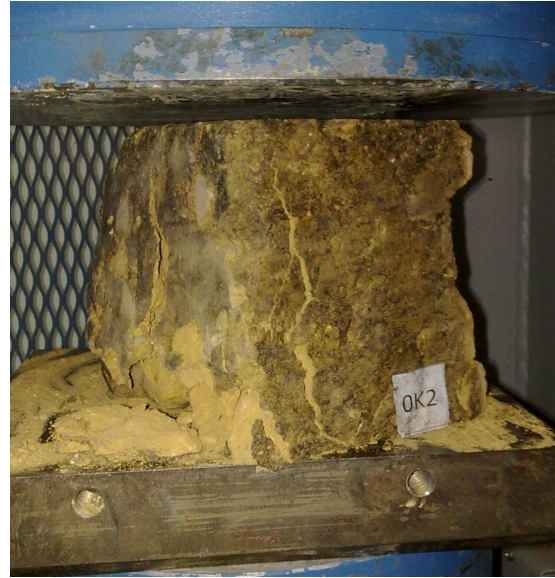
Şekil 4.5: OK2-56 Numunesinin basınç deneyi
