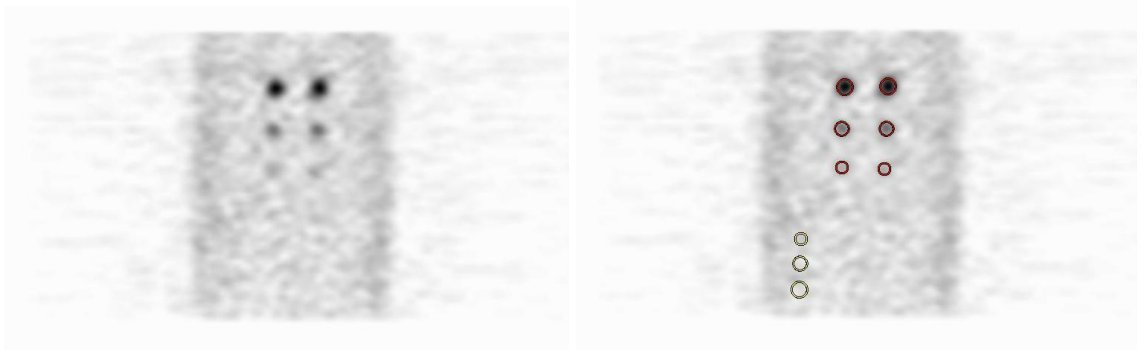
Şekil 4.13: 128x128x16 matris ile alınan SPECT'in NO FILTERS profil ile işlenmesi sonucu elde edilen görüntülerinden kontrast hesabı için seçilen koronel kesit görüntüsü.
