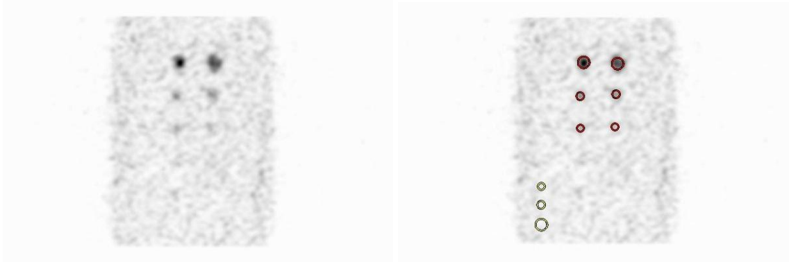
Şekil 4.20: 256x256x16 matris ile alınan SPECT'in MOSEM profil ile işlenmesi sonucu elde edilen görüntülerinden kontrast hesabı için seçilen koronel kesit görüntüsü.
