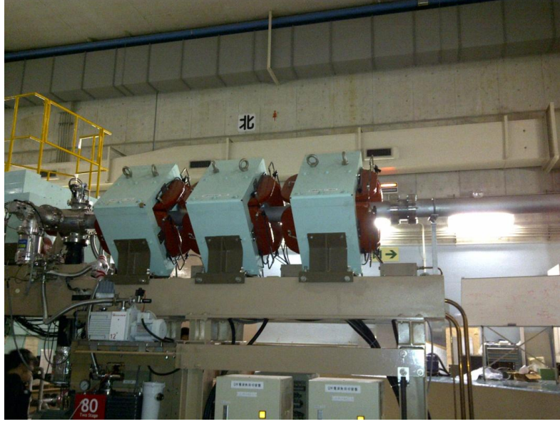
Şekil 3.18: RCNP’de kullanılan kuadrupol magnet görünümü
