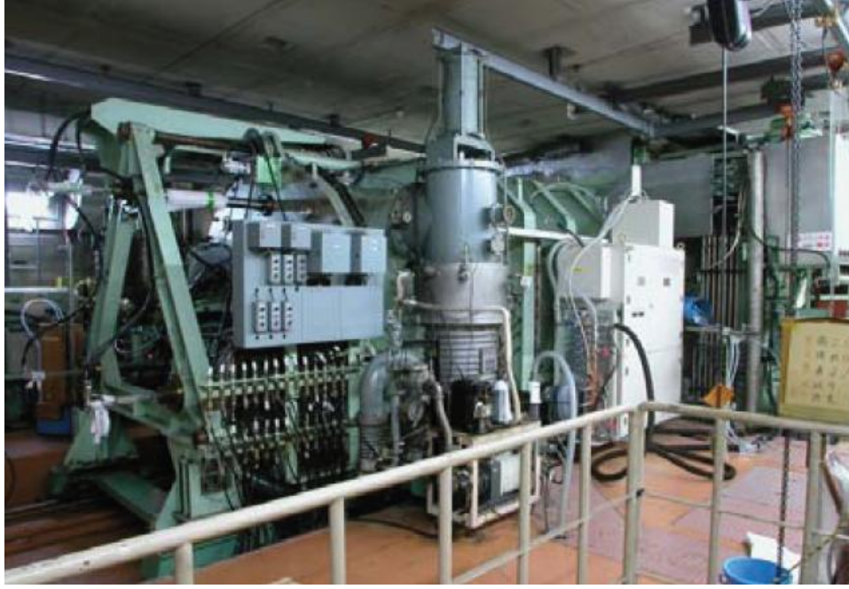
Şekil 3.3: AVF siklotron yapısı
