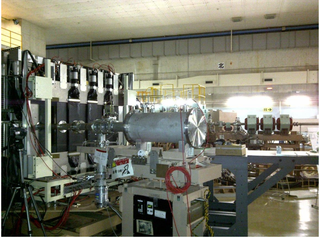
Şekil 3.20: RCNP’de kullanılan 0^\circ Faraday Kap görünümü
