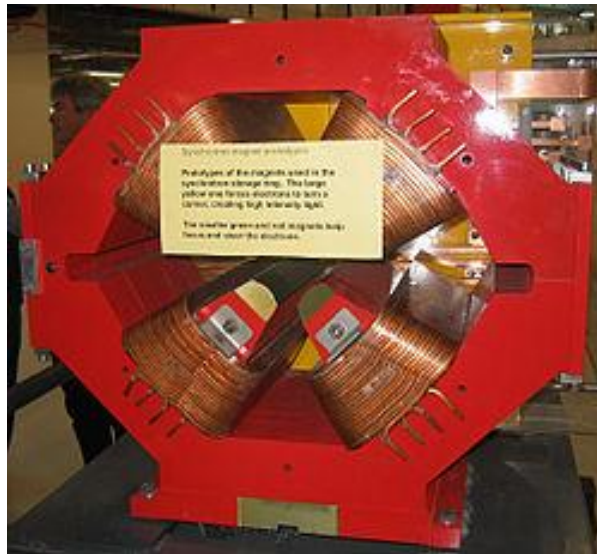
Şekil 3.22: Çok kutuplu magnet yapısı
