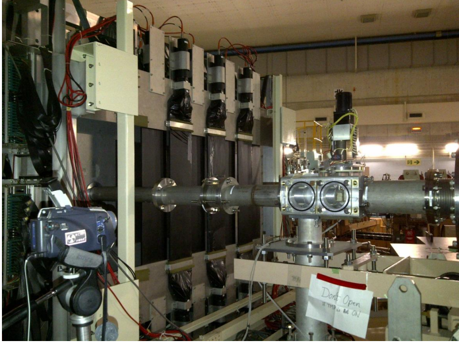
Şekil 3.34: RCNP'de kullanılan 0° Fraday kap görünümü
