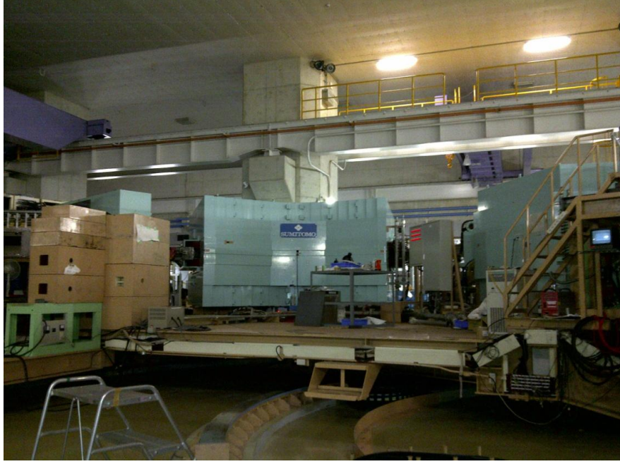
Şekil 3.21: RCNP D1, D2, DSR magnetlerinin görünümü
