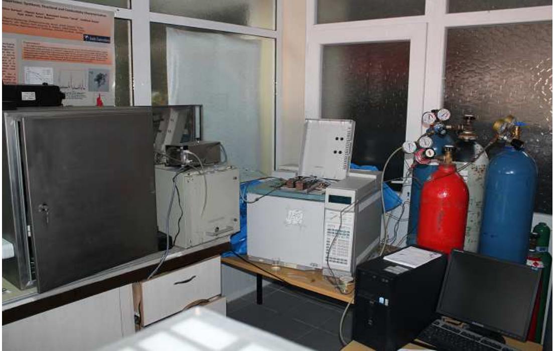
Şekil 3.8: Fotokatalitik hidrojen üretimi ve GC ile analiz deney düzeneği
