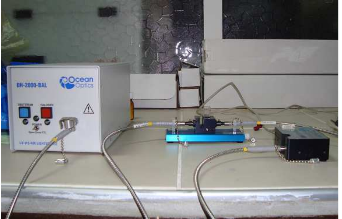
Şekil 3.11: Diffuse reflektans cihazı ile sıvı örnek absorpsans analizi
