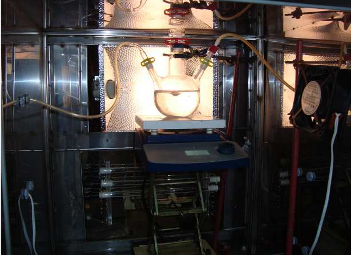
Şekil 3.6: Fotokatalitik hidrojen üretiminin yapıldığı reaksiyon düzeneği
