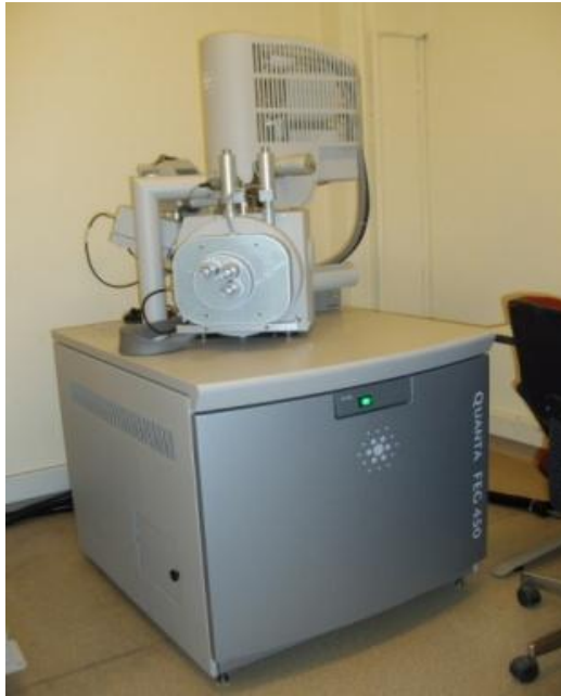
Şekil 3.2: FEI Quanta FEG 450 marka taramalı elektron mikroskobu
