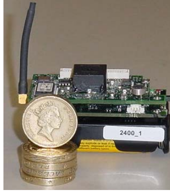
Şekil 1.5: Madeni para ebatlarında bir kablosuz algılayıcı düğüm [17]
