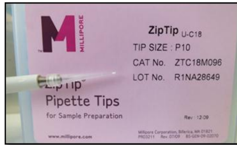
Şekil 3.7: C18 kolon içeren ZipTip pipet ucu.
