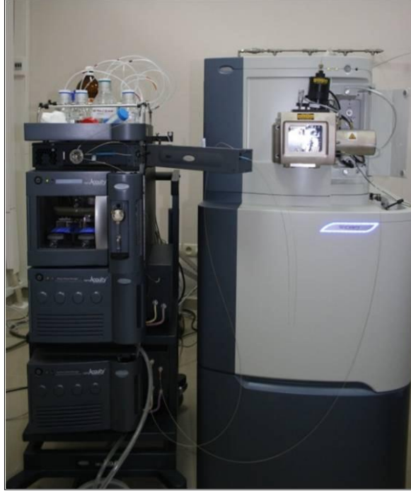
Şekil 3.8: Waters SYNAPT HDMS kütle spektrometri sistemi
