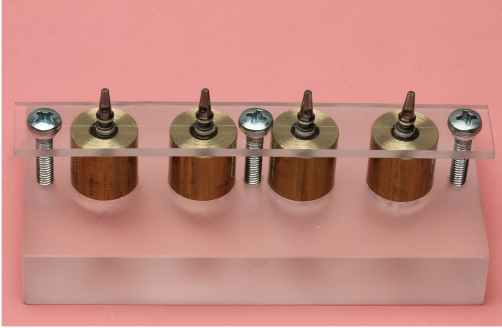
Şekil 3-4: İmplantların reçine içine gömülmesinde kullanılan epoksi cam düzenek
