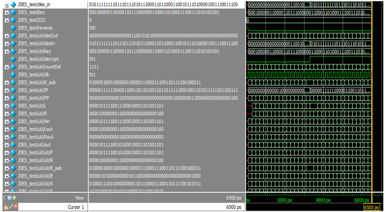
Şekil 4.4. Model Sim üstünde 64 bitlik girişte Des algoritması şifreleme çıkışı
