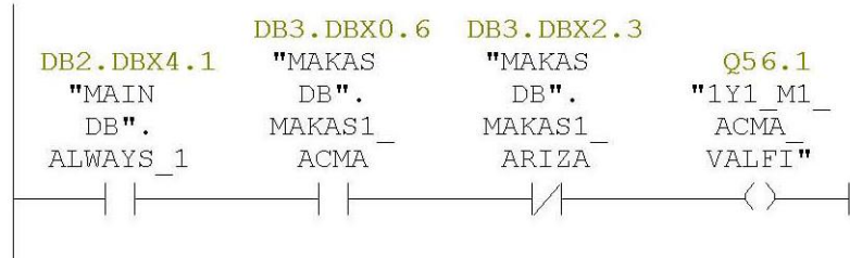
Şekil 4.12: Makas-1 düz yol tanzim valfi enerjileme programı
