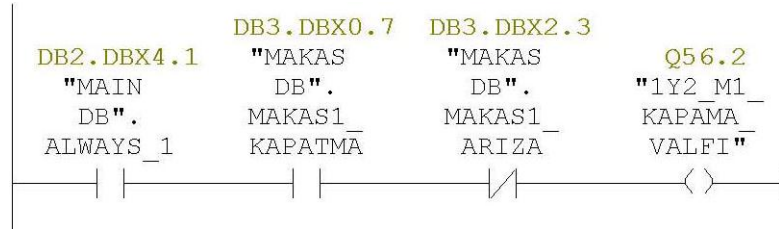
Şekil 4.13: Makas-1 sapan yol tanzim valfi enerjileme programı
