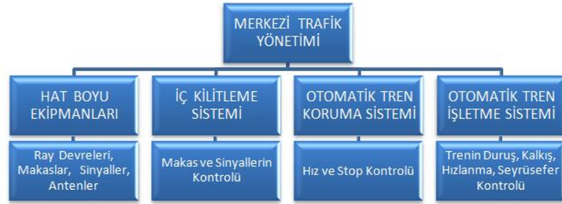
Şekil 2.4: Genel sinyalizasyon sistem mimarisi
