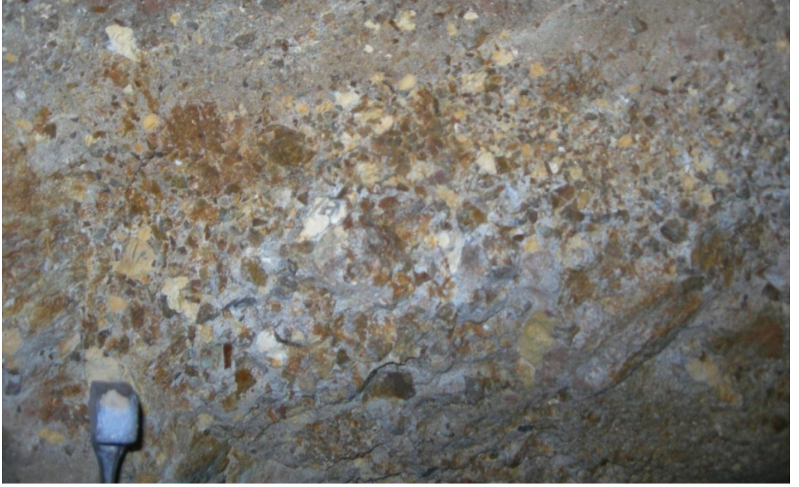
Şekil 4.47. Toprakoturağı Dere'de gölsel sedimentlerin içerisinde açılmış desandride serpantinleşmiş dunitlerin üzerinde bulunan gölsel sedimentlerin tabanındaki breşler.
