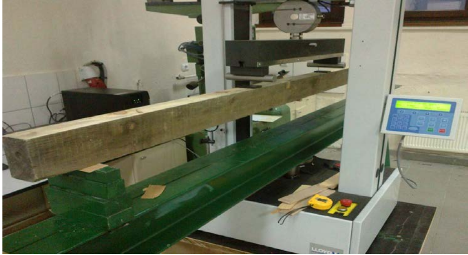
Şekil 3.9 Yapısal Boyuttaki Kerestelerde Tahribatlı Deney Düzeneği
