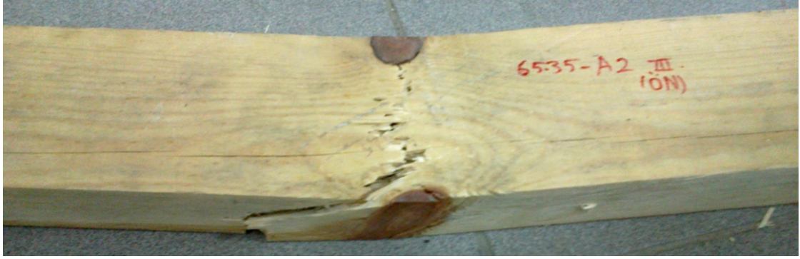
Şekil 5.1: Eğilen Kirişin Budak Sebebiyle Ortadan Kırılması Durumu Örneği
