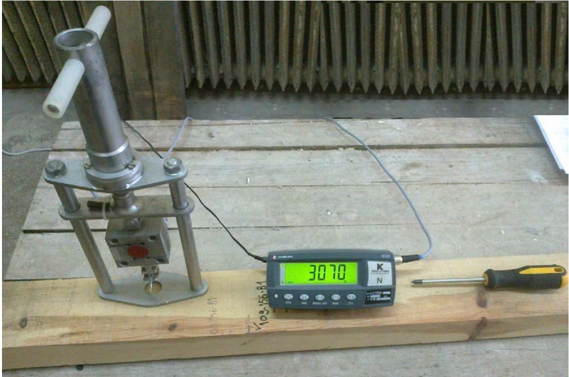
Şekil 3.8: Vida Çekme Cihazı ile Ölçüm
