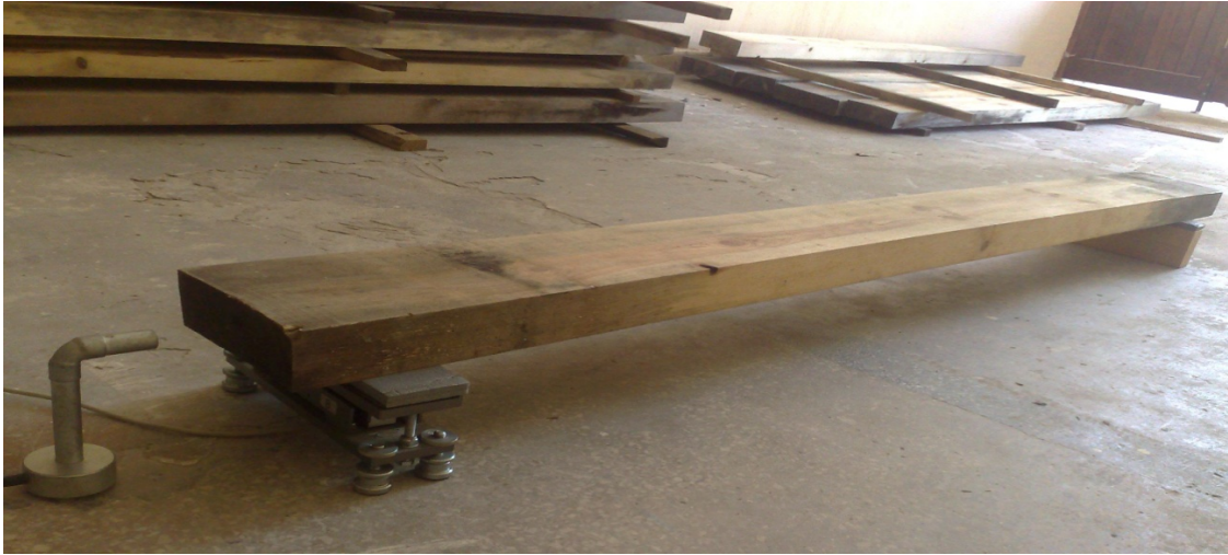
Şekil 3.5 Portatif Kereste Sınıflandırıcı (PLG) Cihazı ile Ölçüm
