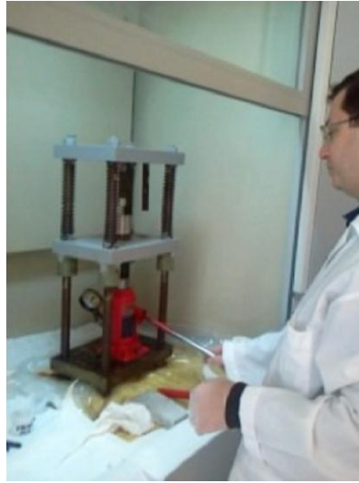
Şekil 3.1 Peletleri basmak için kullandığımız el presi
