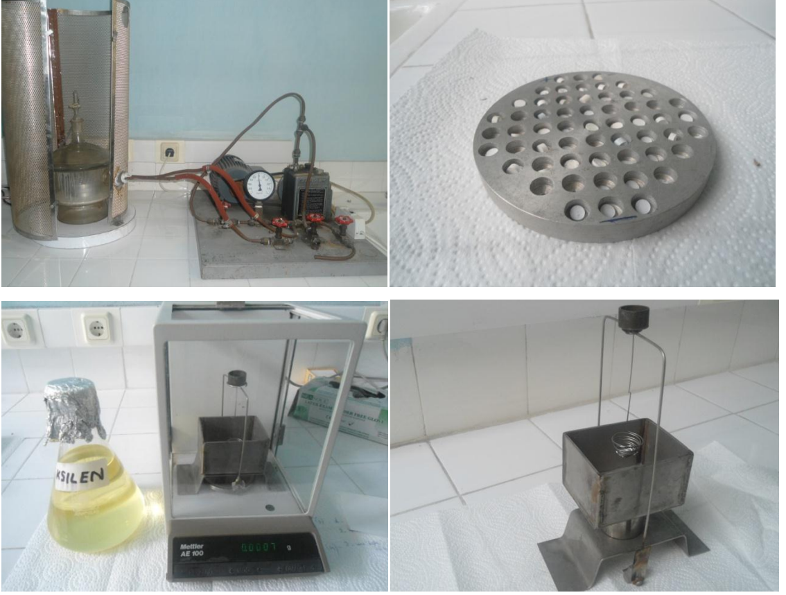
Şekil 3.4 Daldırma yöntemiyle özkütle ve gözeneklilik tayini için kullanılan düzenek
