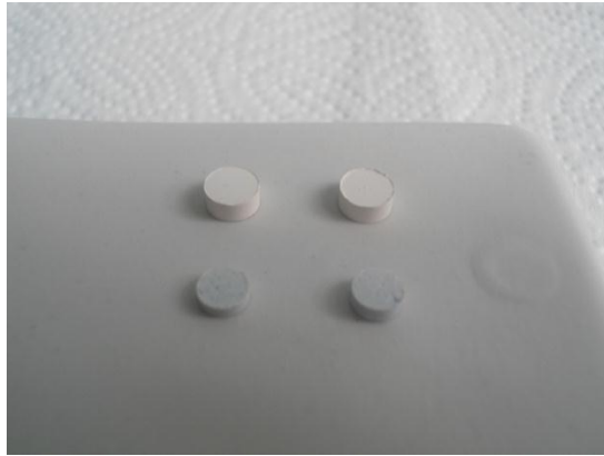
Şekil 3.2 Sinterlenmemiş (arka sıra) ve sinterlenmiş (ön sıra) ROX peletleri
