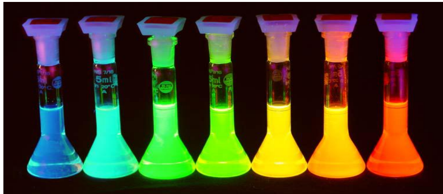
Şekil 2.1 : CdSe/ZnS çekirdek/kabuk yapıdaki kuantum noktalarının fotoluminesans ışımalarının fiziksel boyuta bağlı olarak değişimi. En küçük kuantum noktası mavi, en büyük kuantum noktası ise kırmızı ışımaya yapmaktadır [11].
