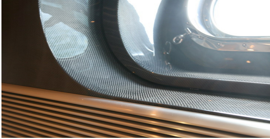
Şekil 2. 13: Yüzeyle Karbon Elyaf ile kaplanmış yat penceresi [34].
