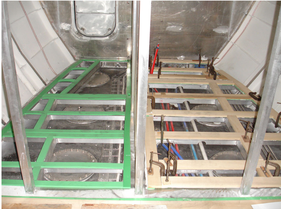
Şekil 2. 4: Yat zeminine uygulanmış sylomer ve şerit çitılar [15].
