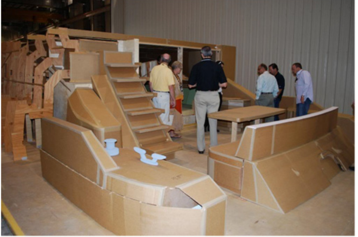
Şekil 2. 11: Yat dışında kurulan postalar ve mock - up [8].
