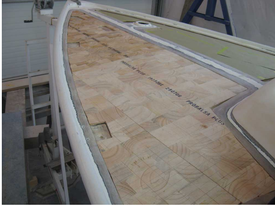
Şekil 2. 6: Düzgün olmayan bir yüzeyde yerine alıştırılmış balsa panel [16].
