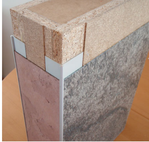
Şekil 2. 17: Esnek taş kaplama uygulama detayı [41].
