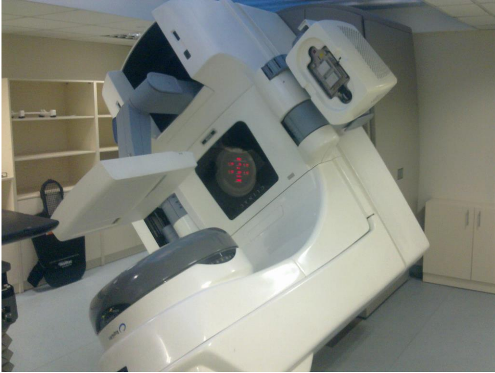
Şekil 3-15: Gantri 120°'de EPID ölçümü
