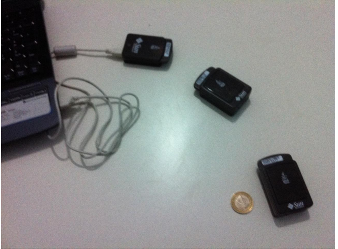
Şekil 3.5 : Deney için Tercih Edilen KAA Platformu: Sun SPOT
