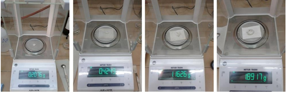
Şekil 4.4: VC60DMA40 jellerinin ŞDD zamanla ölçülmesi
