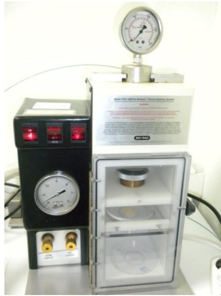
Şekil 3.15- Uygulamaya hazır halde bir partikül bombardımanı sistemi (Fotoğraf: Deniz KÖM)
