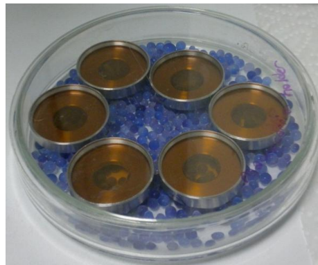
Şekil 3.13- Makro taşıyıcıların ve makro taşıyıcı tutucuların hazırlanması (Fotoğraf: Deniz KÖM).
