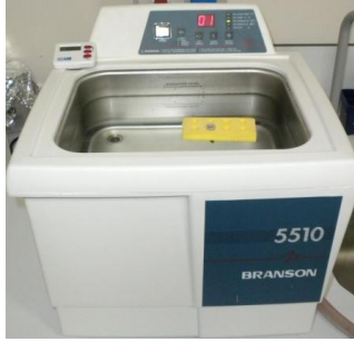
Şekil 3.11- Ultrasonikatör ile altın partiküllerinin homojen olarak dağılması sağlandı (Fotoğraf: Deniz KÖM).
