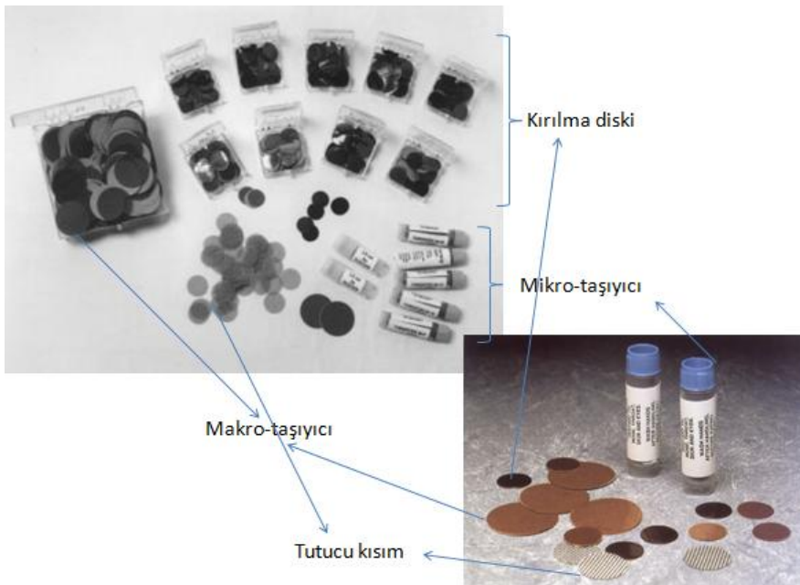
Şekil 2.7- Partikül bombardımanı sisteminde kullanılan değişken bileşenler (Bio-Rad).
