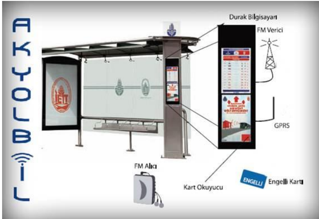
Şekil 2.5: İETT akıllı otobüs durağı yolcu bilgilendirme sistemi (BELBİM, 2012).
