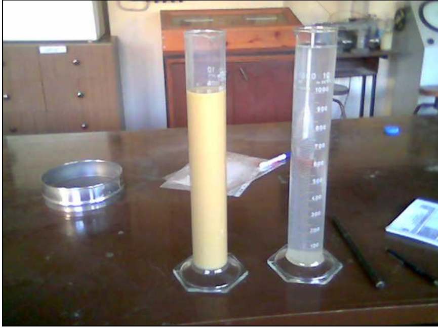
Şekil 3.1. Hidrometre deney aleti
