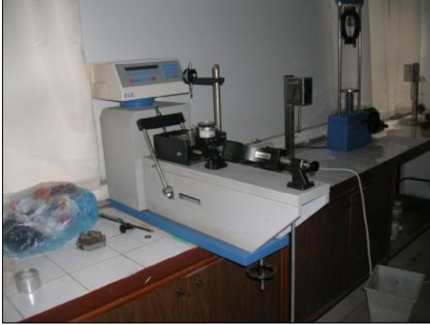
Şekil 3.6. Kesme Kutusu deney aleti
