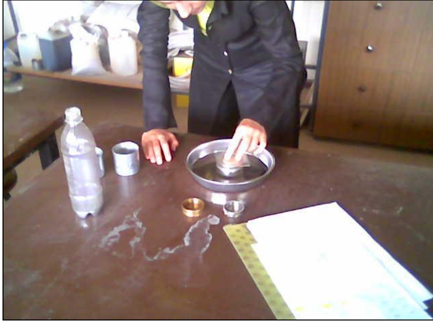
Şekil 3.4. Rötire limit deneyi
