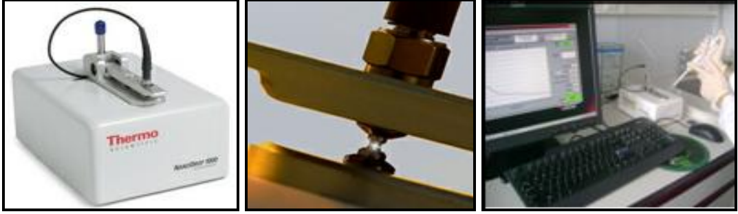
Şekil 3.18- NanoDrop (ND1000) ile DNA'nın konsantrasyonunun belirlenmesi.
