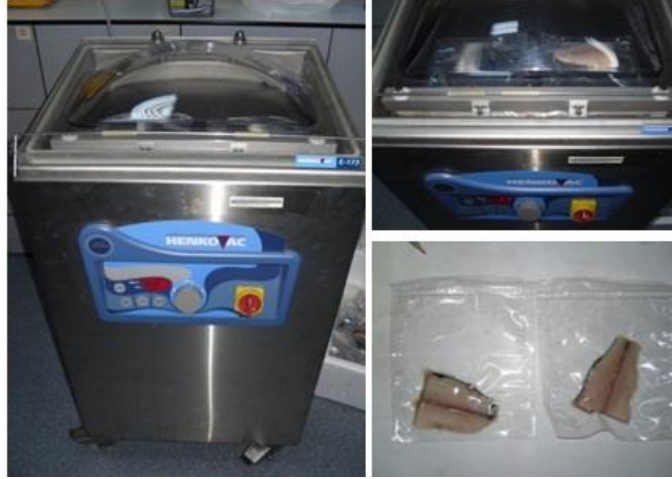
Şekil 3.5: Vakum için kullanılan paketleme makinası ve vakumlanan balık etleri.
