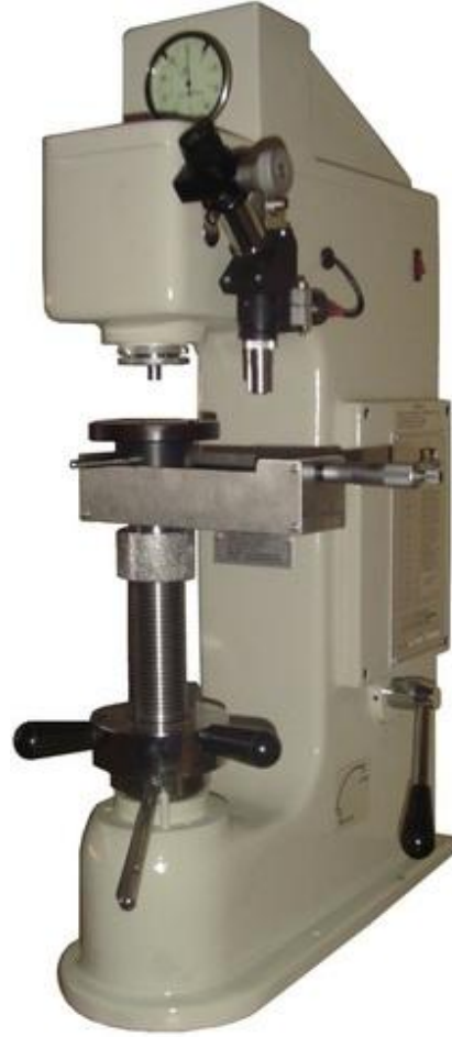
Şekil 3.6: BMS 200-RBOV Vickers Sertlik Ölçüm Cihazı
