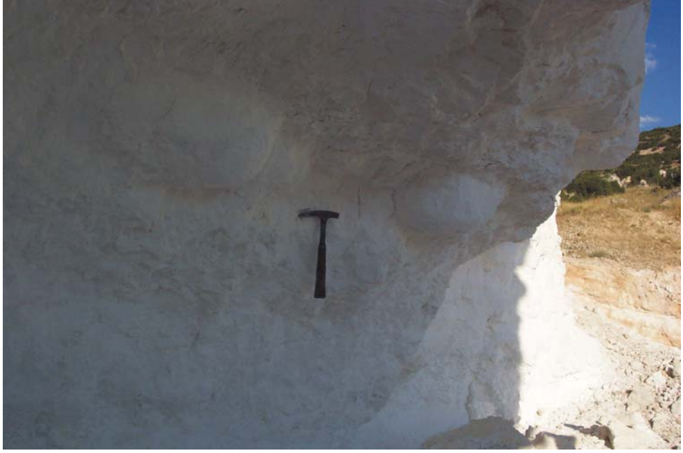
Şekil 4.27. Kemer Sırtı manyezit yarmasının kenar kesimlerinde gözlenen nodüler manyezitler.
