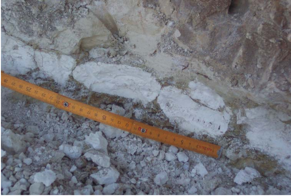
Şekil 4.25 Çapar Tepe yol yarmasında nodüler manyezit oluşumlarının yakından görünümü.
