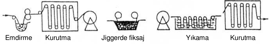
Şekil 5.10. Pad-Jig Tesisinde Şematik İşlem Basamakları (Yakartepe ve Yakartepe, 1998)
