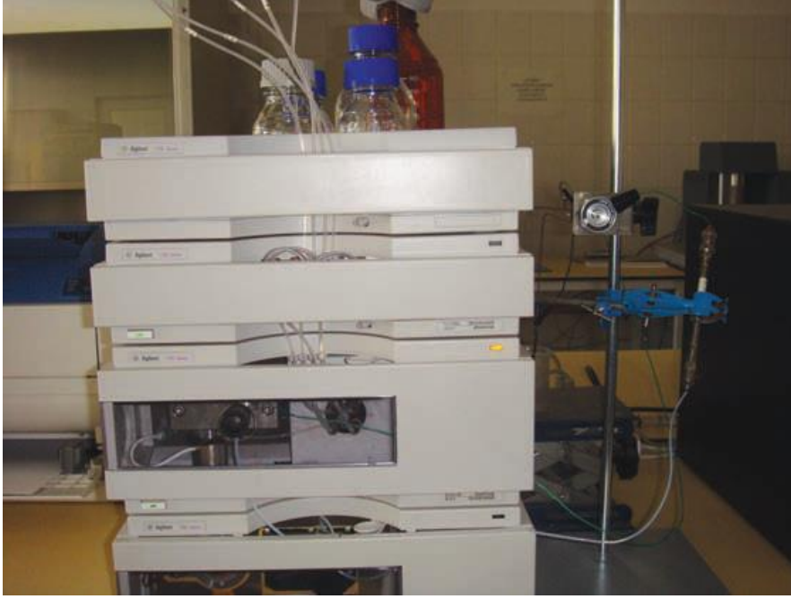
Şekil 2-6: Laboratuvarda kullanılan bir HPLC sistemi
