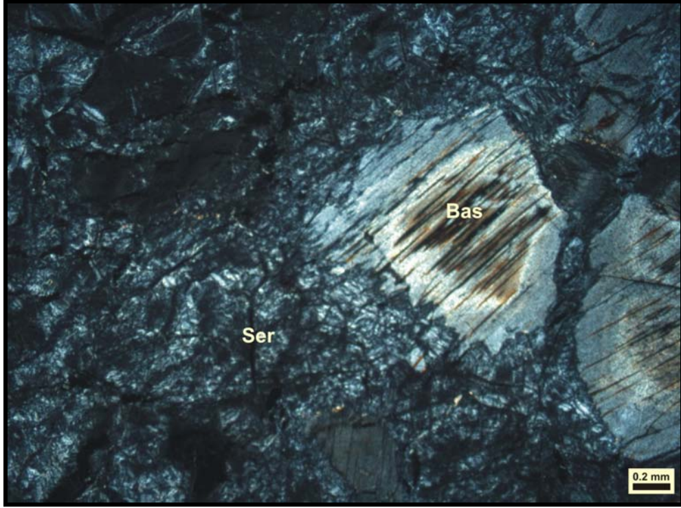
Resim 4.14. Serpantinitlerde elek Doku ve bastitlemiş piroksen görüntüsü (Ç.N. Bas: Bastit, Ser: Serpantin grubu mineralleri)
