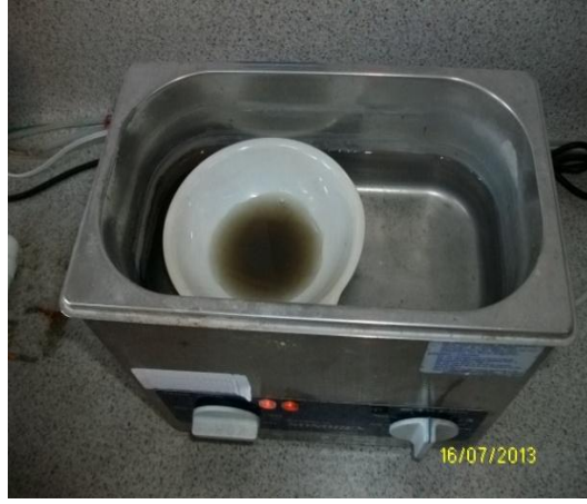
Şekil 3.8 Su banyosundaki bir TKM numunesi.
