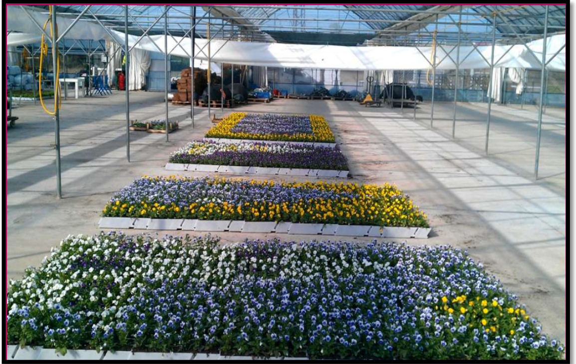
Şekil 2.72: Modüler yaşayan duvarlar için tasarıma uygun bitkiler panellere dikilir ve gruplandırılır. Bitki dikimi yapılan panellerin serada montaj öncesi bakımları yapılır 20 .
