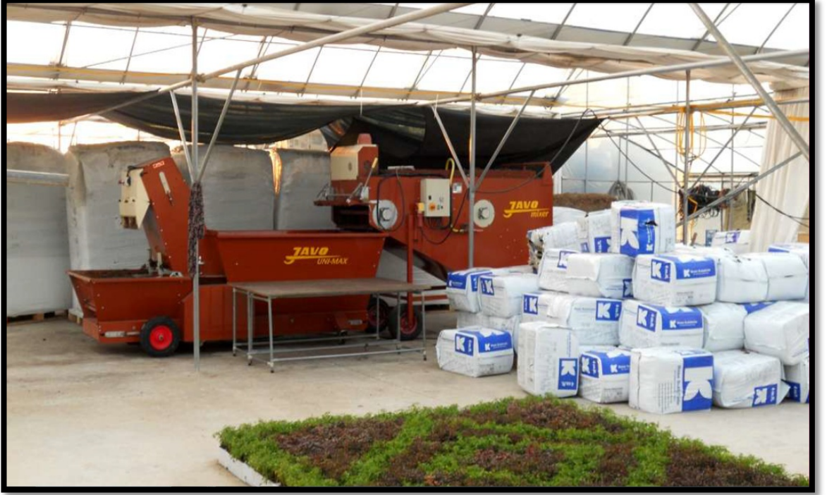
Şekil 2.69: Modüler yaşayan duvarlar için özenle seçilen materyaller mikserde homojen olması için karıştırılır ve makine yardımı ile paneller harçla doldurulur 20 .
