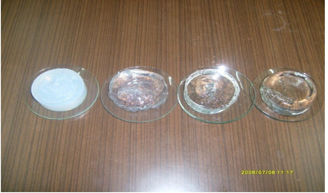
Şekil 4.42: Soldan sağa doğru: n_{AAm} = 0.175 mol; n_{AAm}/n_{MBAA} = 25, 50, 100, 200 olan hidrojellerin yeni jelleşmiş görüntüsü.
