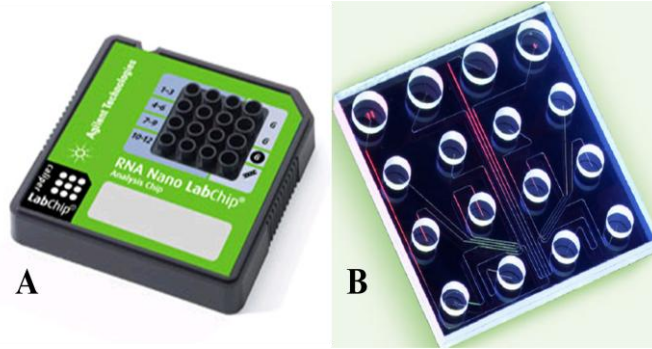
Şeki 2.7: (A) Agilent'in 6000 Nano Çipi. (Agilent RNA 6000 Nano Kit Guide'dan alınmıştır 1 ). (B) Çiplerde yerleştirilen mikrokanallar. (Lab-on-Chip.gene-quantification'den alınmıştır 2 ).
