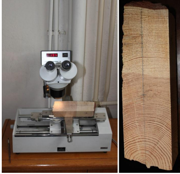
Şekil 3.10: Eclund Brinell Mikroskopunda yıllık halka genişlik ölçümü.
