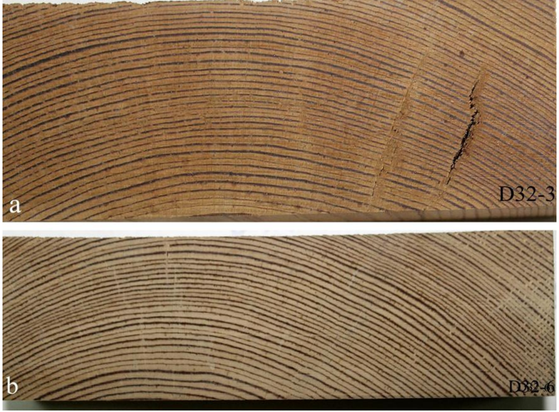
Şekil 4.11: Yerli sarıçam Thermo-D uygulanmış öz odun; a:orta kısım, iç çatlak oluşumu, b:uç kısım, oluklaşma (Fotoğraf makinesi görüntüsü).
