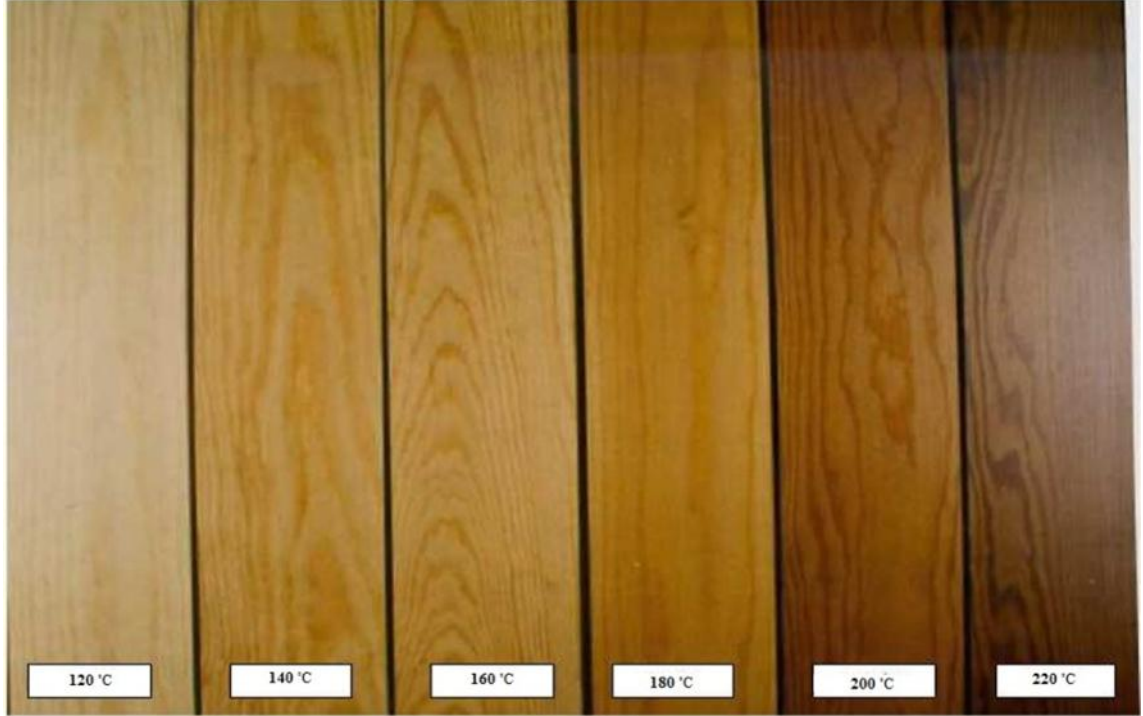
Şekil 2.5: Thermowood uygulanmış çam odunundaki sıcaklığa bağlı görülen renk değişimleri (Anon., 2003).
