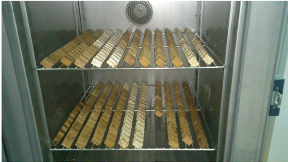
Şekil 3.13: İklimlendirme kabininde hava kuru hale getirilen örnekler.
