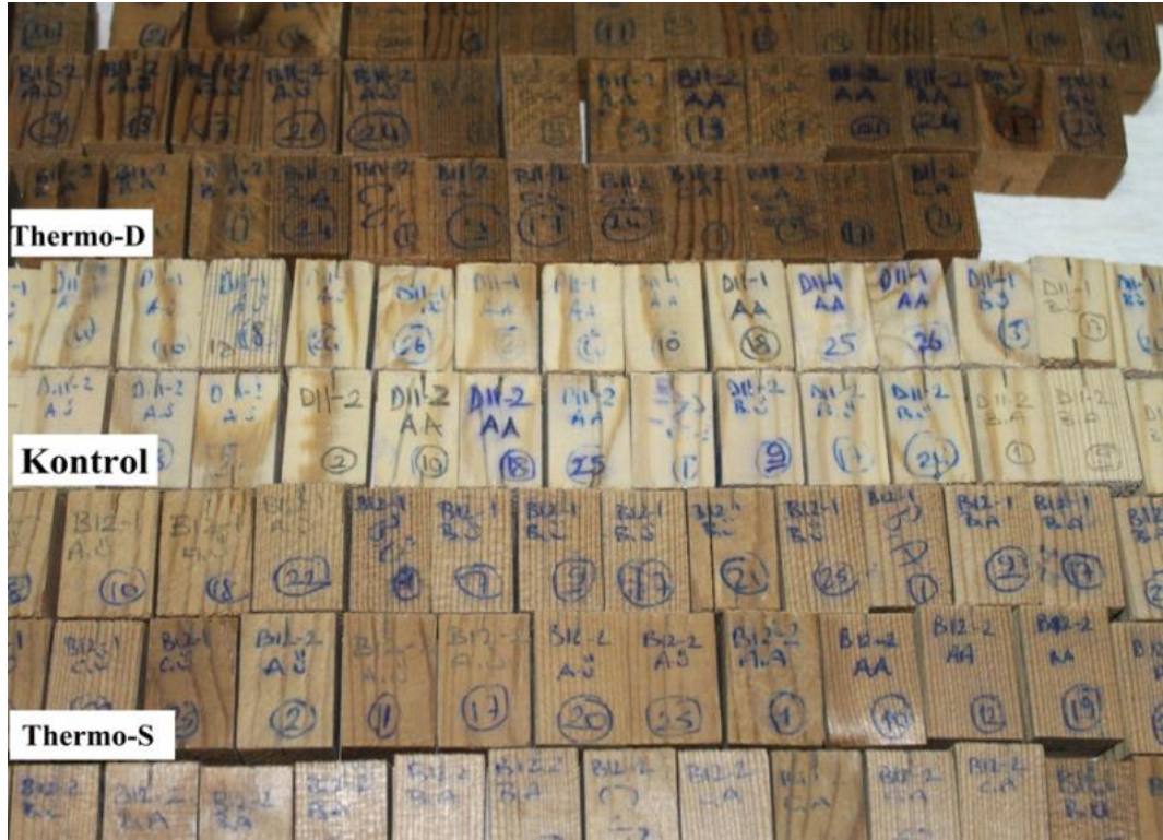
Şekil 4.3: Isıl işlem uygulaması sonucu oluşan renk değişikliği.
