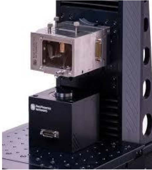
Şekil 3.6: AKM ölçümlerinin alındığı Nanomagnetics Instruments AKM sistemi.
