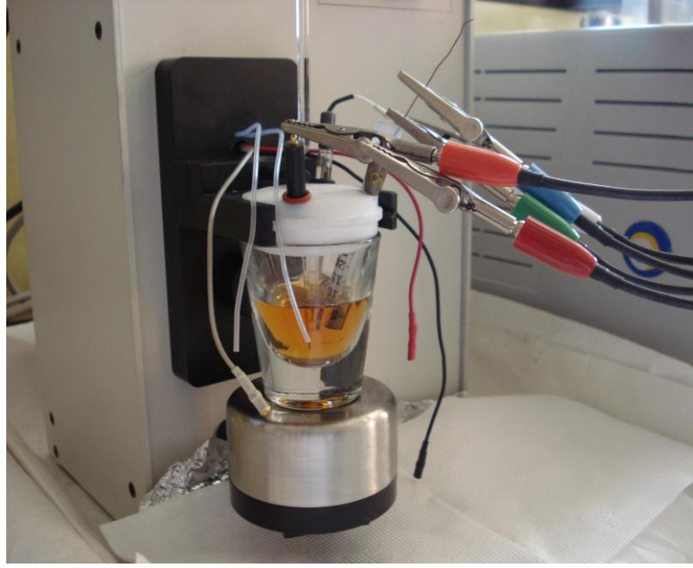
Şekil 3.8: BAS hücresi ve üçlü elektrod sistemi.
