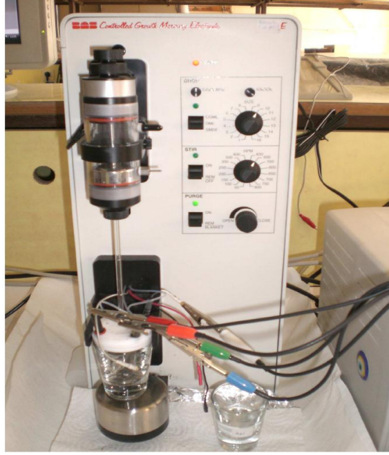
Şekil 3.5: Voltametrik deneylerin gerçekleştirildiği Gamry Reference 600 Potansiyostat/Galvanostat ZRA sistemi.
