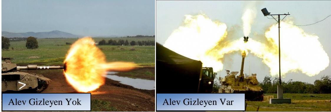
Şekil 6 : Alev gizleyen yapısının atış esnasında namlu gazı dağılımına etkisi.
